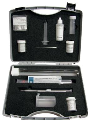
Il kit di collaudo di Hyprolyser<sup>®</sup> contiene tutti gli strumenti, i contenitori e i reagenti necessari all'esecuzione dei test di routine e di servizio che confermano e controllano il buon funzionamento del sistema.
