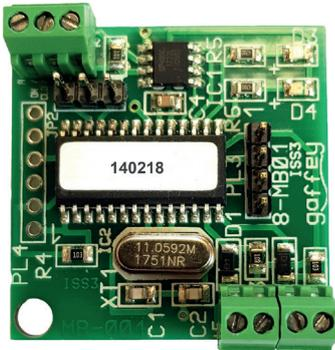
Modbus RTU-Modul als Option erhältlich.
