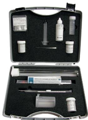
Il kit di collaudo di Hyprolyser® contiene tutti gli strumenti, i contenitori e i reagenti necessari all'esecuzione dei test di routine e di servizio che confermano e controllano il buon funzionamento del sistema.
