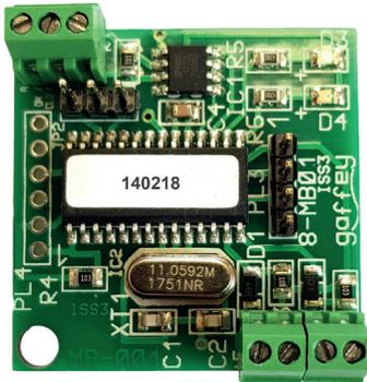
Modbus RTU-Modul als Option erhältlich.
